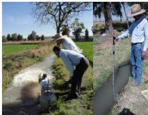
Figura 1. Medidor de gasto con Propela (izquierda), medidor digital de velocidad para válvula de riego parcelaria (derecha).
